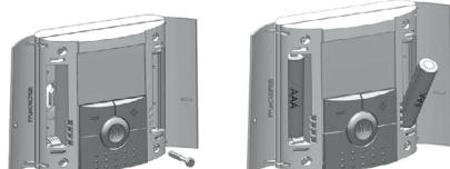
Öffnen Sie die beiden Seitenklappen und setzen Sie die Batterien unter Einhaltung der Polarität ein oder entfernen Sie die beiden Schutzlaschen, falls das Produkt vollständig mit Batterie geliefert wird (in diesem Fall ist es möglich, dass die Batterien eine geringere Autonomie haben, je nach Aufbewahrungsduer des Thermostats).
