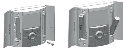
Abrir las dos puertas laterales e introducir las baterías respetando la polaridad, o bien, quitar las dos lengüetas de protección si el producto se provee con las baterías (en ese caso es posible que las baterías tengan una
