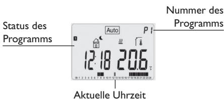
Um die Hintergrundbeleuchtung des Displays wieder einzuschalten, wenn sie ausgeschaltet ist, müssen Sie kurz die Taste **OK** drücken.
