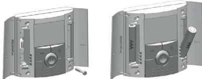
Aprire i due sportelli laterali ed inserire le batterie rispettando la polarità oppure rimuovere le due linguette di protezione se il prodotto è fornito completo di batterie (in questo caso è possibile che le batterie abbiano
