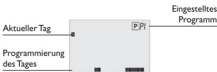
Wenn man auf den Programmiermodus zugreift, muss zuerst mit den Tasten **[+]** und **[-]** der gewünschte Programmiermodus ausgewählt werden.
