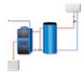
Λέβητας στερεών καυσίμων, αυτόνομη εγκατάσταση με δοχείο αδρανείας (buffer tank).
