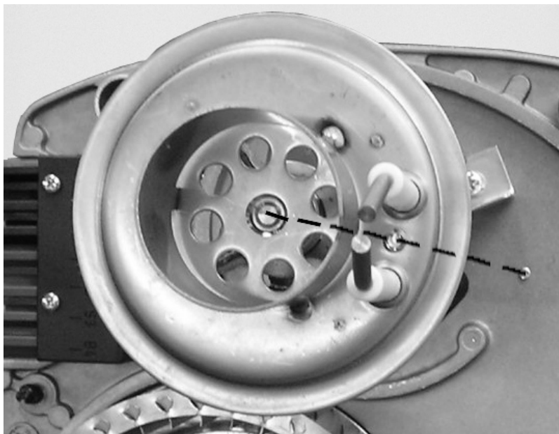
σχ. 34: Τοποθέτηση συστήματος μείξης και ευθυγράμμιση ηλεκτροδίου ανάφλεξης (απόσταση ηλεκτροδίων ανάφλεξης 2-3 mm)
