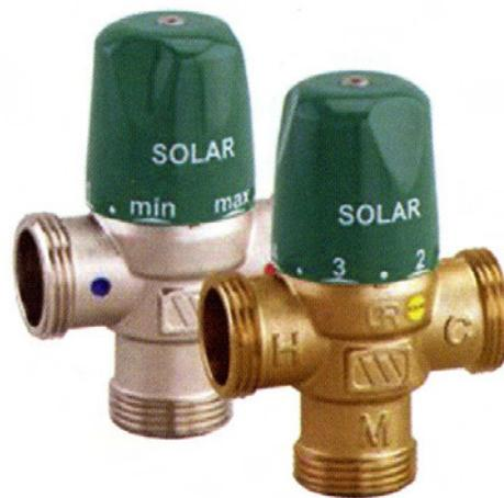
Για το λόγο αυτό απαιτείται η χρήση της ειδικής θερμοστατικής βαλβίδας ανάμιξης MMV-SOLAR, η οποία είναι ειδικά σχεδιασμένη για ηλιακά συστήματα με μεγάλες παροχές και υψηλές θερμοκρασίες νερού. Εξασφαλίζει σταθερή θερμοκρασία του ζεστού νερού χρήσης στο σημείο εξόδου της, η οποία μπορεί να ρυθμιστεί από 30 έως 60 oC, για προστασία του τελικού χρήστη.
