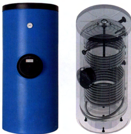
Εικ. 5: Θερμοδοχείο Styleboiler, τριπλής ενέργειας με δύο σταθερούς εναλλάκτες. Στον κάτω εναλλάκτη γίνεται η σύνδεση με τους ηλιακούς συλλέκτες και στον πάνω εναλλάκτη η σύνδεση με την βοηθητική πηγή ενέργειας.
